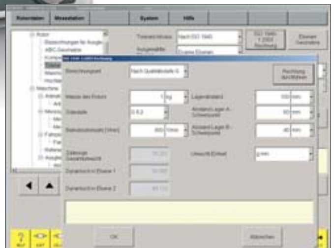
Cálculo de tolerâncias de balanceamento conforme DIN ISO 1940
