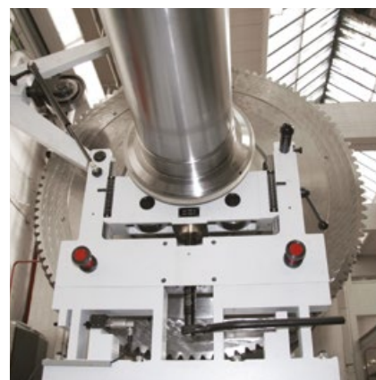
Pedestal HM: robustos e compactos, com alta rigidez, elevada linearidade e baixo amortecimento. Utilização do princípio subcrítico Schenck, com a seção intermediária do pedestal projetada como um dinamômetro de alta resistência. Os captadores são montados fora da área de atuação das forças e, assim, insensíveis a impactos.
